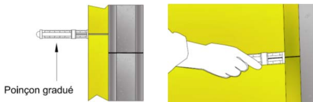
Figure 1 : Contrôle de l'épaisseur
